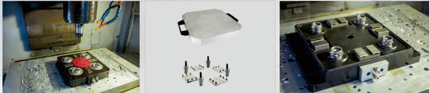
▲ 机床台面上的UPC可作为接口, 连接工件托板载体, 换装无需费时, 可立即完成, 这样保持生产的连续性
