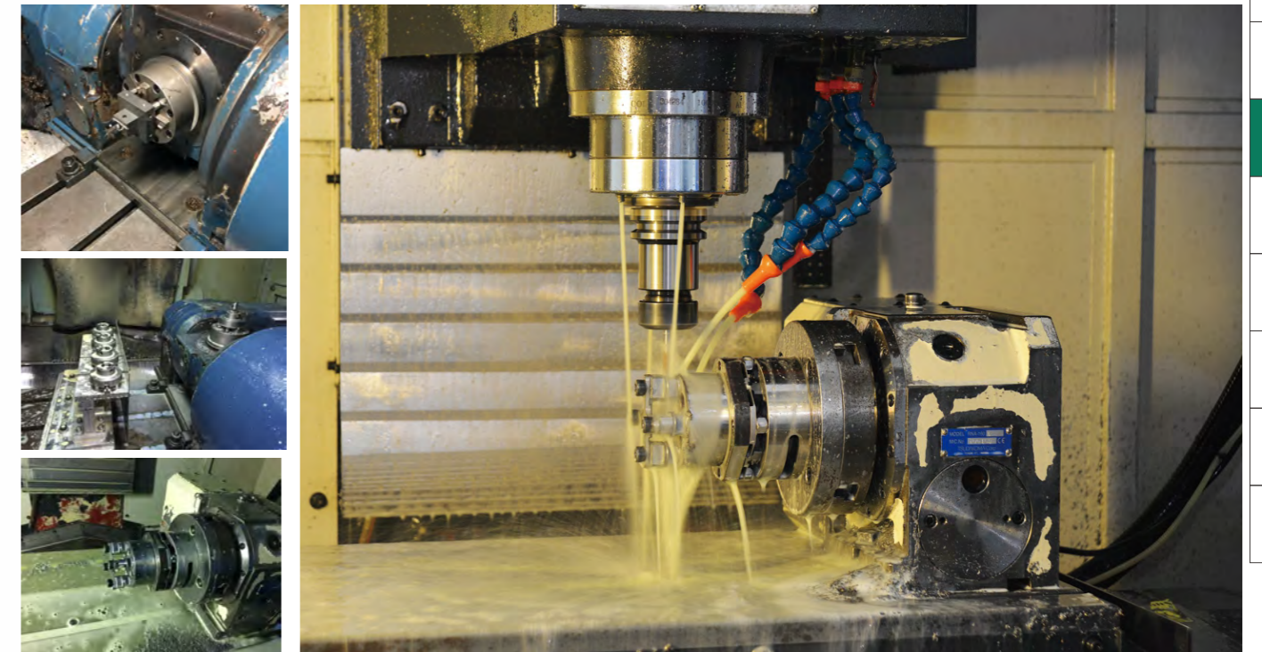
▲小型四轴五轴转台安装卡盘，在加工零件时便可机外安装，快速更换产品线
