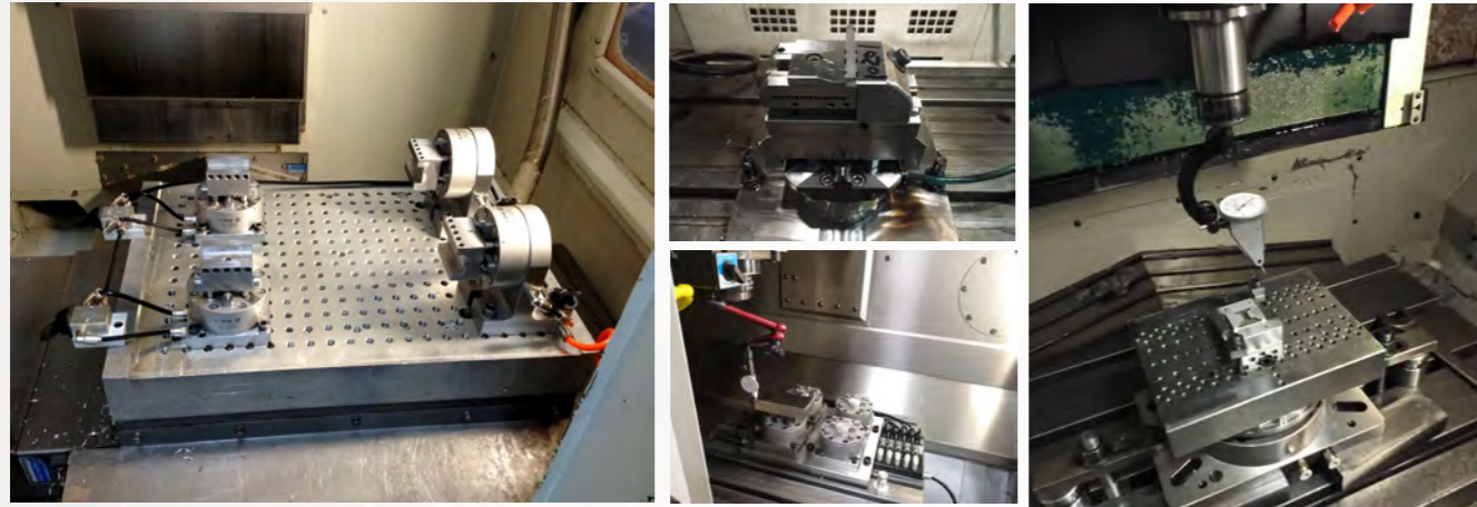
▲可根据实际加工需求选用100型气动卡盘,150型强力卡盘 ▲R型气动卡盘实现快速换装,重复定位精度0.002mm
