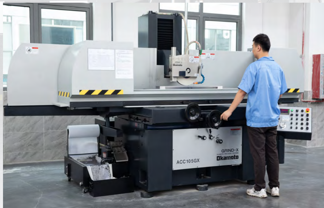
OKAMOTO 冈本平面磨床 ACC105GX 工作台行程: 1150*540
