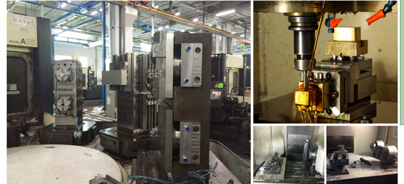
▲使用A-ONE卡盘系列产品，在立式加工中心,卧式加工中心上,轻松实现多面加工提高生产效率
