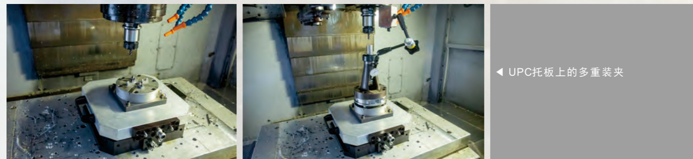
▲ 机床台面上的UPC可作为接口, 连接工件托板载体, 换装无需费时, 可立即完成, 这样保持生产的连续性
